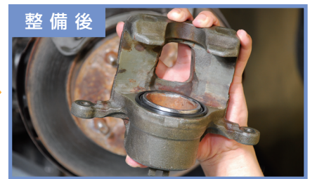
ブレーキ・キャリパから液漏れが無く、ゴム部品が新品の状態
