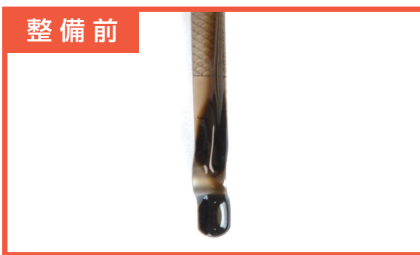
エンジン・オイルが汚れている状態
