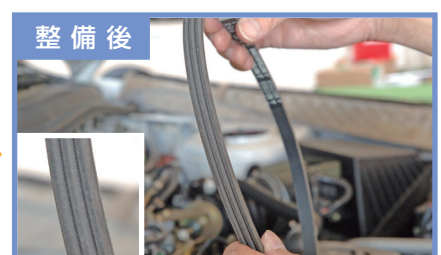
補機ベルトが新品の状態（写真は車両への取付前の状態）
