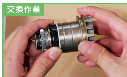
ホイール・シリンダ内部を分解清掃し、内部の部品を交換流
