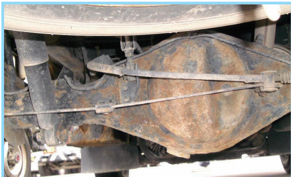
凍結防止剤の付着等により、フレームの腐食が進み、亀裂が生じてしまった状態
