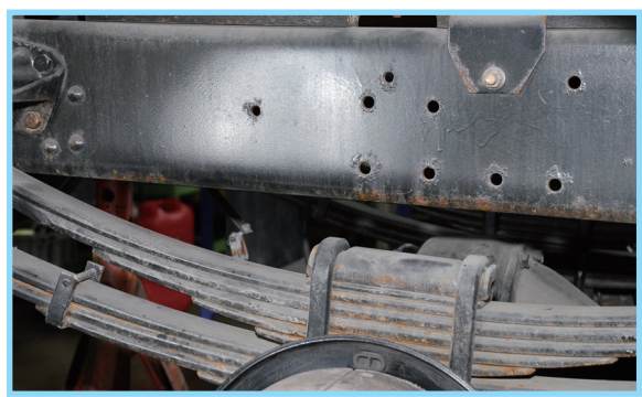
下廻り塗装が経年劣化し、シャシ(足廻り)部品に腐食が生じてしまった状態
