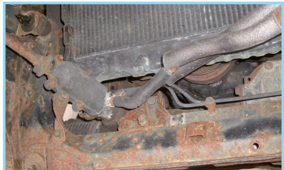
凍結防止剤の付着等により、フレームの腐食が進み、亀裂が生じてしまった状態
