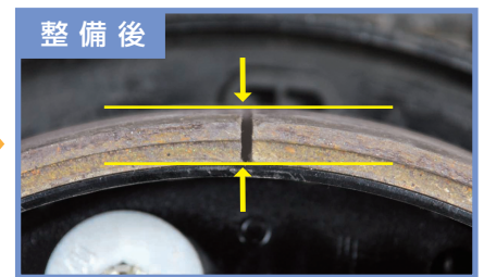
ブレーキ・シュー(ライニング)が新品の状態
