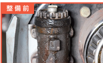
ホイール・シリンダのゴム部品が劣化し、液漏れしてる状態
