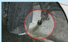
破損した前輪と車体をつなぐ装置
