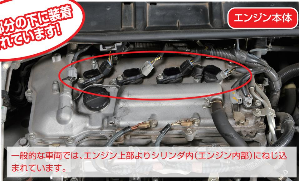
一般的な車両では、エンジン上部よりシリンダ内(エンジン内部)にねじ込まれています。
