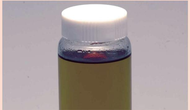
ブレーキ・フルードは油圧に変換したペダル踏力をブレーキ装置に伝える役目をしている重要な油脂です。常に補助タンクの通気口から空気中の水分等を吸収し劣化していき、フルード内に気泡が発生しやすくなり油圧が適切に伝わらずにブレーキの効きが悪くなる恐れがありますので、定期的な交換が必要です。
