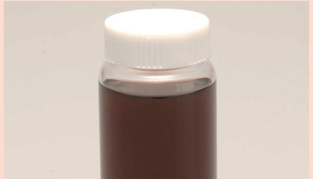
エンジン冷却液は、エンジンの熱を吸収してラジエータで放熱することによりエンジンを冷却しています。その他にもラジエータなどの冷却システムの金属部品内部の錆びを防いだり、冬場の凍結を防ぐ働きをしています。エンジン冷却液の劣化や液量・濃度不足によってオーバーヒートしたり、冷却システムの錆の発生や凍結によるラジエータの破損の原因になるので適切な時期に交換することが必要です。
