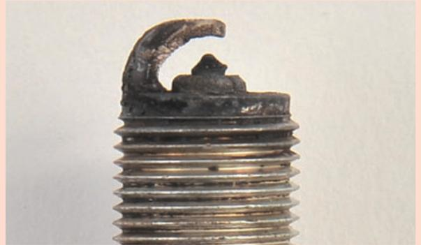
ガソリンエンジンは、燃料と空気を混ぜた混合気を燃焼させて動力を発生させています。混合気を燃焼させるためには点火する必要があり、その役割を担っているのがスパーク・プラグです。スパーク・プラグは使用しているうちに中心電極の先端が丸く消耗していき、火花の飛びが悪くなり、混合ガスへ安定して着火されなくなる可能性があります。そうすると、エンジン出力の低下・燃費の悪化・エンジン寿命への悪影響を与えるおそれがありますので、適切な時期に交換することが必要です。
