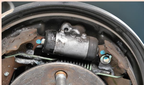
ブレーキ・ホイール・シリンダはマスタ・シリンダからの油圧によりブレーキを効かせる働きをしており、内部のピストンには機密性を保つためにゴムシールが使用されています。シール類はゴム部品のため摩擦や油圧による伸縮の繰り返しにより劣化していき、最悪の場合液漏れ等を起こしブレーキの効きが悪くなりますので、適切な時期に交換することが必要です。
