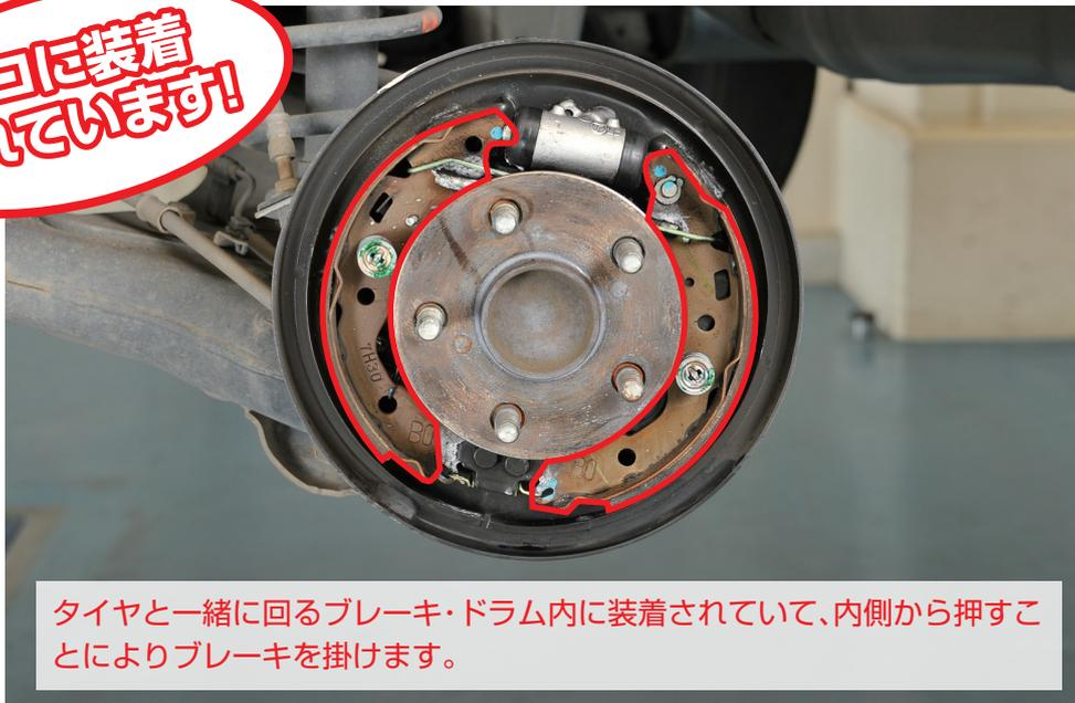
タイヤと一緒に回るブレーキ・ドラム内に装着されていて、内側から押すことによりブレーキを掛けます。
