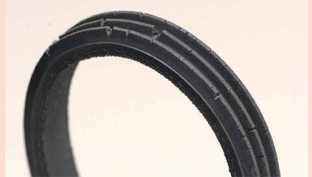
補機ベルトは、エンジンの回転を利用してオルタネータ(発電機)、ウォーターポンプ(冷却水循環装置)、エアコンのコンプレッサ、パワーステアリングポンプ等を動かすために動力を伝達しているベルトです。ゴム製品であることから使用しているうちに劣化、ひび割れ、伸び等が発生し、滑りや切断により、各補機の機能が失われる可能性がありますので適切な時期に交換することが必要です。
