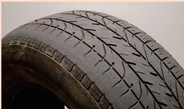
タイヤは路面と唯一接地している部品であり、クルマの「走る・止まる・まがる」の基本的な性能を左右する重要な部品です。ゴム製品であり使用するうちに経年劣化による亀裂発生や摩耗することから、摩耗限度に達する場合や安全を確保できない経年劣化や損傷が認められた場合は交換が必要です。
