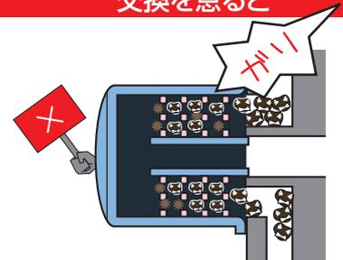
目詰まりにより、ろ過不能となり、エンジン内部損傷。
