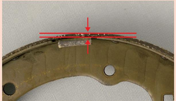
ブレーキ・シューはタイヤと一緒に回るブレーキ・ドラムを内側からおさえつけることによりブレーキを効かせる重要な部品です。ブレーキ・シューには摩擦材が使用されており、使用するうちに摩耗していき、摩擦材が無くなってしまふとブレーキが不安定になり、ブレーキ・ドラムにも損傷を与えてしまふので、摩耗して残量が少なくなっている場合は交換が必要です。
