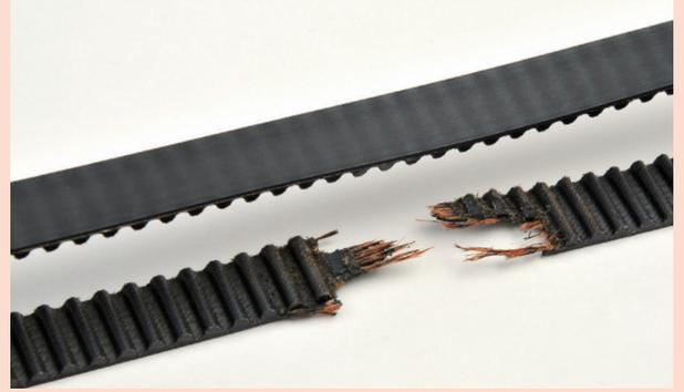
タイミング・ベルトは、エンジンのクランクシャフトと吸排気バルブを開閉するカムシャフトを連動させるための重要な部品です。走行中にタイミング・ベルトが切れると、吸排気バルブが開閉できなくなりエンジンが停止し、再始動できなくなります。最悪の場合には、バルブの動くタイミングがずれることで、シリンダ内でピストンとバルブが干渉し、エンジン自体が深刻なダメージを負うこともありますので適切な時期に交換することが必要です。
