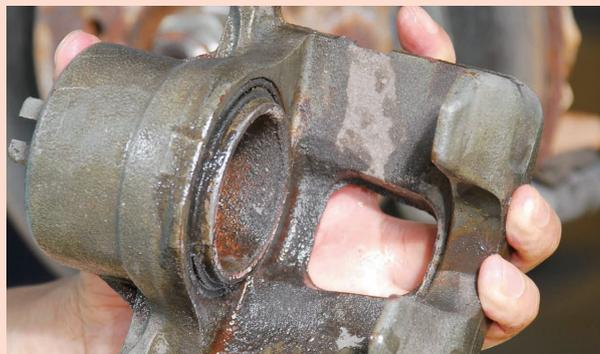
ブレーキ・ディスク・キャリパはマスタ・シリンダからの油圧によりブレーキを効かせる働きをしており、内部のピストンには機密性を保つためにゴムシールが使用されています。シール類はゴム部品のため摩擦や油圧による伸縮の繰り返しの繰り返しにより劣化していき、最悪の場合液漏れ等を起こしブレーキの効きが悪くなりますので、適切な時期に交換することが必要です。
