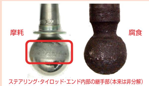
ステアリング・タイロッド・エンド内部の継手部(本来は非分解)
