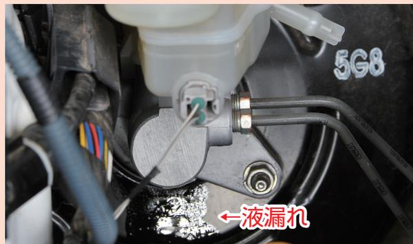
ブレーキ・マスタ・シリンダはブレーキのペダル踏力を油圧に替える働きをしており、内部のピストンには機密性を保つためにゴムシールが使用されています。シール類はゴム部品のため摩擦や油圧による伸縮の繰り返しにより劣化していき、最悪の場合液漏れ等を起こしブレーキの効きが悪くなりますので、適切な時期に交換することが必要です。
