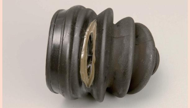
ドライブ・シャフトはトランスミッション等からの動力をタイヤに伝える働きをしており、ハンドル操作やサスペンション作動のために継手部が設けられています。この継手部にはベアリングが使用されていて、車両の下廻りに露出していることから、保護のためにブーツが装着されています。ブーツはゴム部品のため、経年劣化しますので、劣化や損傷が認められた場合は交換が必要です。
