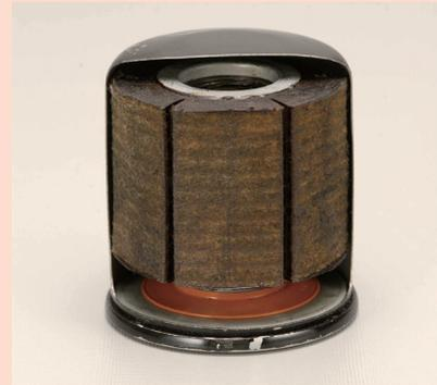
エンジン・オイルをろ過し、汚れを取り除く働きを担うのがオイル・フィルタです。エンジン・オイルの汚れには、金属粉(削りかす)、カーボン(燃え残りカス)などがあり、適切な時期に交換を行わないとフィルタが目詰まりをおこします。フィルタの目詰まりにより汚れの除去ができなくなるとエンジンに重大な損傷を与えるおそれがあるので、定期的な交換が必要です。
