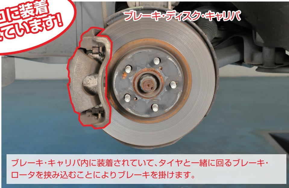
ブレーキ・キャリパ内に装着されていて、タイヤと一緒に回るブレーキ・ロータを挟み込むことによりブレーキを掛けます。
